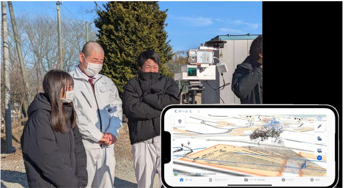
生徒による Geo Scan 長距離スキャナー（スマート地上型レーザーสキャナー）を用いた 3次元測量
